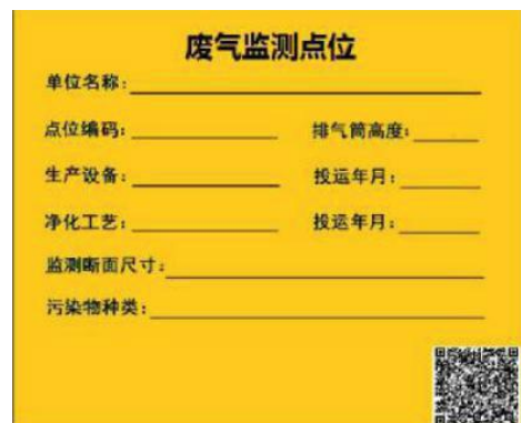
警告性废气检测点位标志牌
